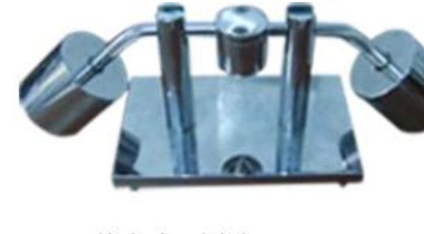
اختبار ضغط الكرة الغلاف
